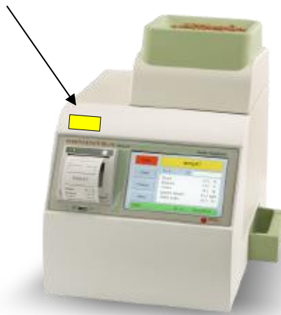
Slika 4. Mjesto za postavljanje ovjernog žiga u obliku naljepnice
